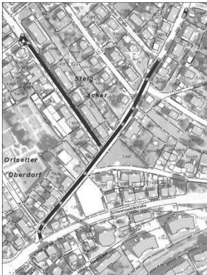
Anschließend soll im 3. Bauabschnitt die Mittelnaht in der „Schreckensteinststraße“ geschlossen und die Großpflasterfläche im Kreuzungsbereich zur „Breslauerstraße“ durch Asphalt ersetzt werden. Auch hier bestehen temporäre Straßensperrungen. Über den Zeitraum dieser drei Maßnahmen ist ein Parkverbot im betroffenen Straßenbereich angeordnet. Entsprechende Beschilderung wird von der ausführenden Baufirma vorgenommen. Bitte um Beachtung.
